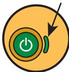
Wenn der AED ausgeschaltet ist, muss die Aktivitätsstatusanzeige (ASI) grün blinken. Wenn die Anzeige rot blinkt bzw. durchgehend rot leuchtet oder wenn kein Licht blinkt, muss das Gerät gewartet werden.
