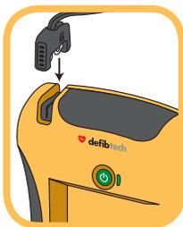
Den Stecker des Elektrodenkabels in den dafür vorgesehenen Elektrodeneingang links oben am DDU-2300 AED wie abgebildet einstecken. Den Elektrodenstecker fest einstecken, bis er vollständig im Gerät sitzt. Der Stecker passt nur in einer Richtung. Wenn der Stecker nicht passt, umdrehen und erneut versuchen.
